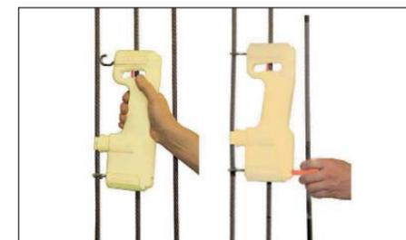
La registrazione delle molle ai terminali delle funi con regolazioni a "lume di naso" costituiscono, al più, un metodo approssimativo di regolazione. Diverse case costruttrici di ascensori hanno fatto in modo che le molle passino sopra i bulloni di fissaggio delle funi e sotto quelli dei dadi di regolazione, in modo da smorzare le vibrazioni.
